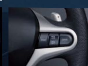
ระบบควบคุมความเร็วอัตโนมัติ (Cruise Control)
