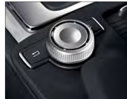
Controller สำหรับควบคุมฟังก์ชันการทำงานต่าง ๆ ติดตั้งอยู่เหนือพนักวางแขนที่คอนโซลกลาง
