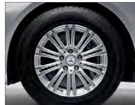
ล้ออัลลอยขนาด 17" พร้อมยาง 245/45 R17 สำหรับ ELEGANCE
