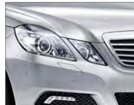
ไฟหน้าแบบไบซีนอน (bi-xenon) พร้อมระบบฉีดน้ำทำความสะอาดไฟหน้า และไฟสำหรับกลางวันแบบ LED*
